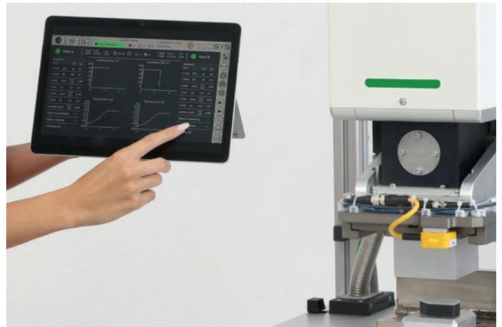
Qualität: Neben den üblichen Parametern wird in allen Evosys-Maschinen auch der gesamte zeitliche Verlauf aller prozessrelevanten Größen überwacht und ausgewertet.
