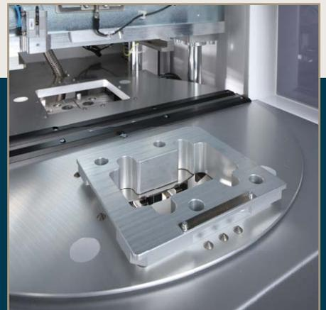
Die eigens für die EvoWeld optimierten Kalibrierwerkzeuge ermöglichen die schnelle Überprüfung der wesentlichen Prozessparameter mit geringstem Zeitaufwand. Dabei führt unsere Prozesssoftware EvoLaP den Maschineneinsteller komfortabel durch das jeweilige Prozedere, doku-
