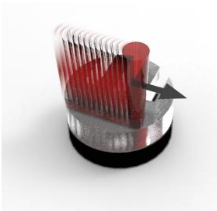
Abbildung: Prinzip Quasisimultanschweißen
